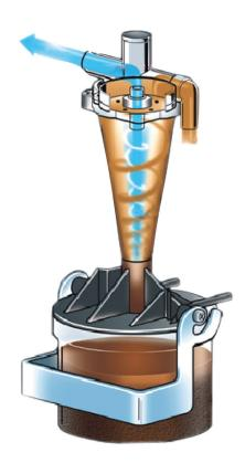
Il liquido in uscita da Turbo-Smart (in funzione di pompa di drenaggio) al suo ingresso nell'Idrociclone assume un moto rotatorio discendente, arrivato nel punto più stretto del cono, si verifica l'inversione di direzione e di rotazione, in quel momento le particelle di amalgama, si depositano sul fondo del vasetto collegato al cono dell'Idrociclone, mentre il liquido, depurato dall'amalgama, esce dall'alto del cono. La portata dell'Idrociclone ISO è di 18/l min.
