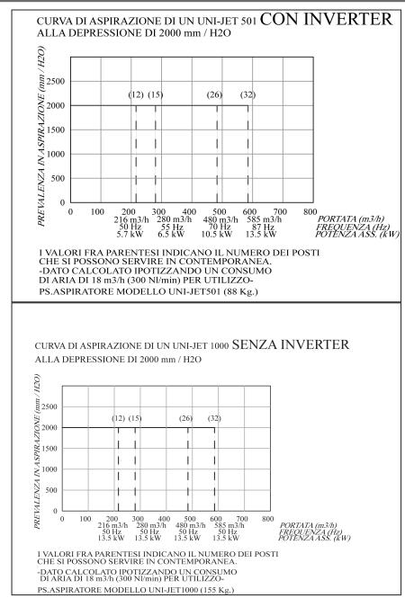
Le curve di aspirazione evidenziano il risparmio energetico che consente l'utilizzo di un Uni-Jet 501 abbinato al VSD, nei confronti di un Uni-Jet 1000 con valvola di compensazione: alla portata di 216 m3/h, il risparmio di energia elettrica risulta di 7,5 kW/h - a 480 m3/h il risparmio è ancora di 3 kW/h - viceversa alla portata di 585 m3/h, la potenza assorbita dai due gruppi aspiranti è quasi equivalente.
